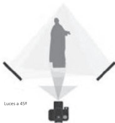
**Imagen 4.** Esquema de iluminación empleando dos fuentes de luz
